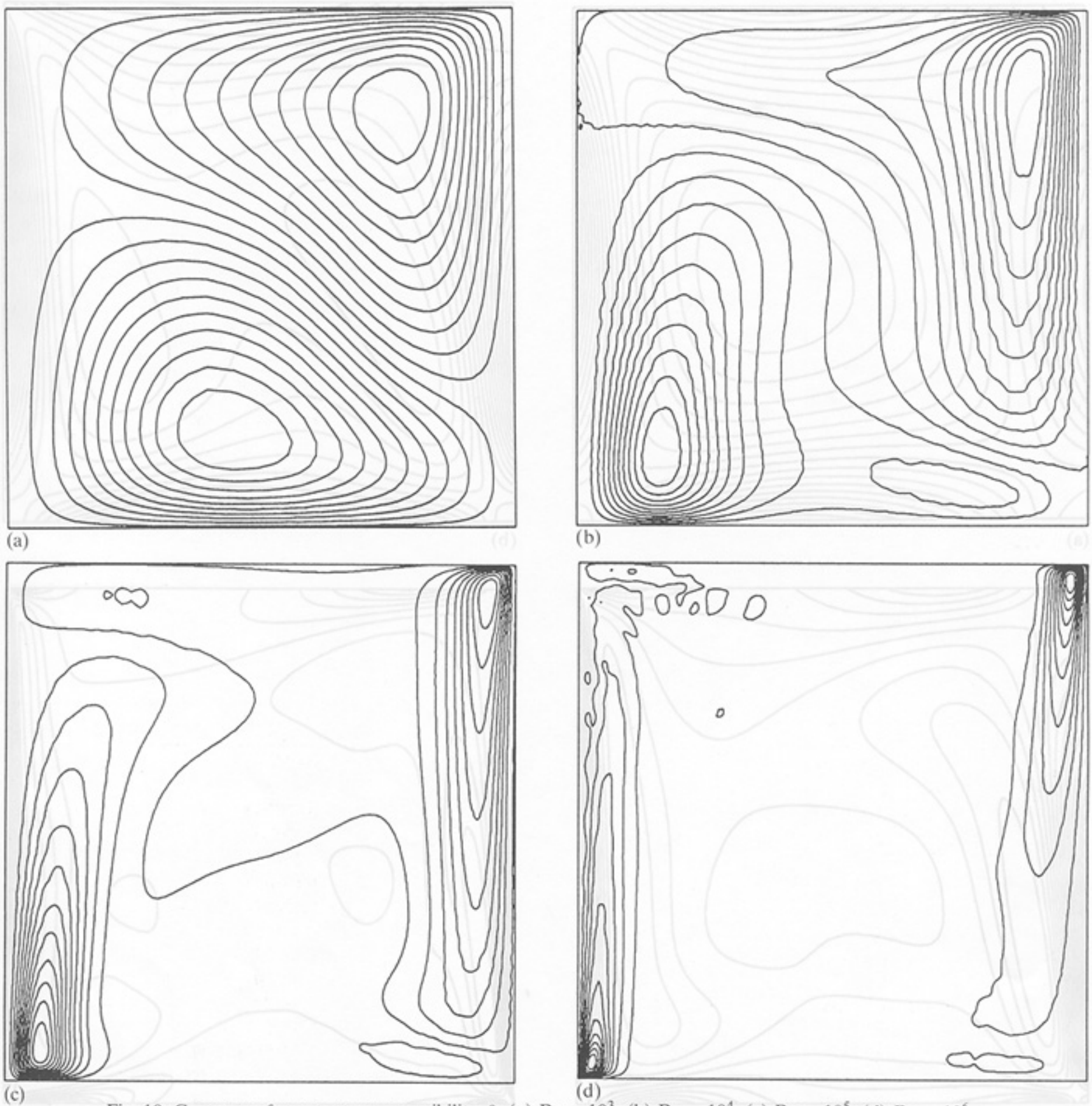
Fig. 10. Contours of constant compressibility \theta : (a) Ra = 10^3 ; (b) Ra = 10^4 ; (c) Ra = 10^5 ; (d) Ra = 10^6 .
